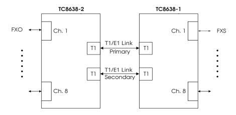
TC8638 Redundant Block Diagram
